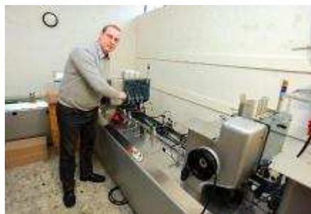
Mathias Lachmann demonstriert die Kuvertiermaschine, die 12 000 Briefe in der Stunde verarbeiten kann. Foto: Volk
